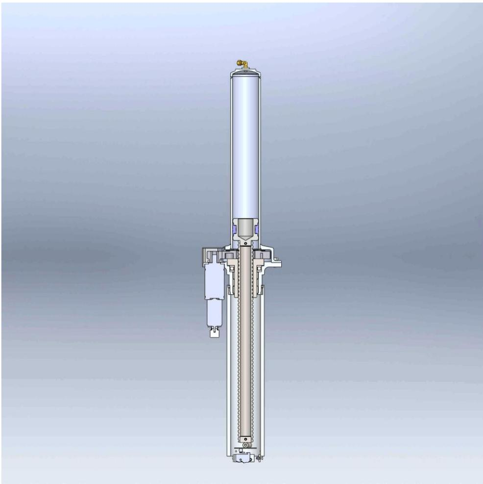
Le pilotage de la Pression et du Volume du GéoPAC est essentiellement assuré par un piston, dans un cylindre de volume adapté à la gamme des sondes proposées par la norme ISO 22476-4:2021.
